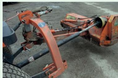
Epareuse permettant de traiter les bandes latérales de part et d'autre des chaussées (largeur dite de sécurité)
