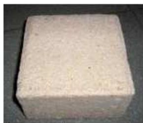
Pavés en béton poreux
